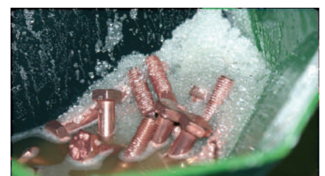
Abb. 4: Schrauben im Prozessschritt Kupferflash
